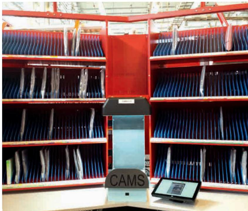
L'efficacité des opérations de tri manuel est fortement liée à l'ergonomie du poste de travail. La compacité du CAMS permet de l'intégrer soit sur meuble indépendant du casier de tri soit directement dans le casier de tri en fonction des contraintes de chaque opérateur. Le casier de tri de Norway Post, fourni par le danois TRECO, comprend 640 cases verticales qui peuvent accueillir des plis de tous formats. L'ergonomie de ce poste a été optimisée par le passé. Afin
